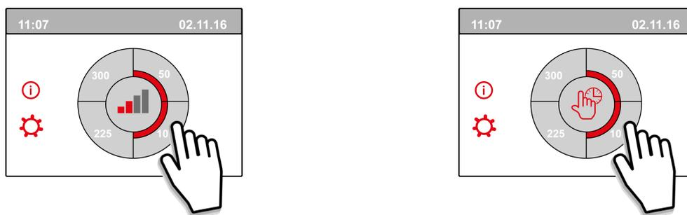
Um die Lüftungsstufe schnell zu ändern, kann im Hauptfenster auf einen der Viertelkreise gedrückt werden. Die so eingestellte Lüftungsstufe bleibt eine halbe Stunde lang aktiv; dies wird im Display durch eine Hand mit Uhr angezeigt.
