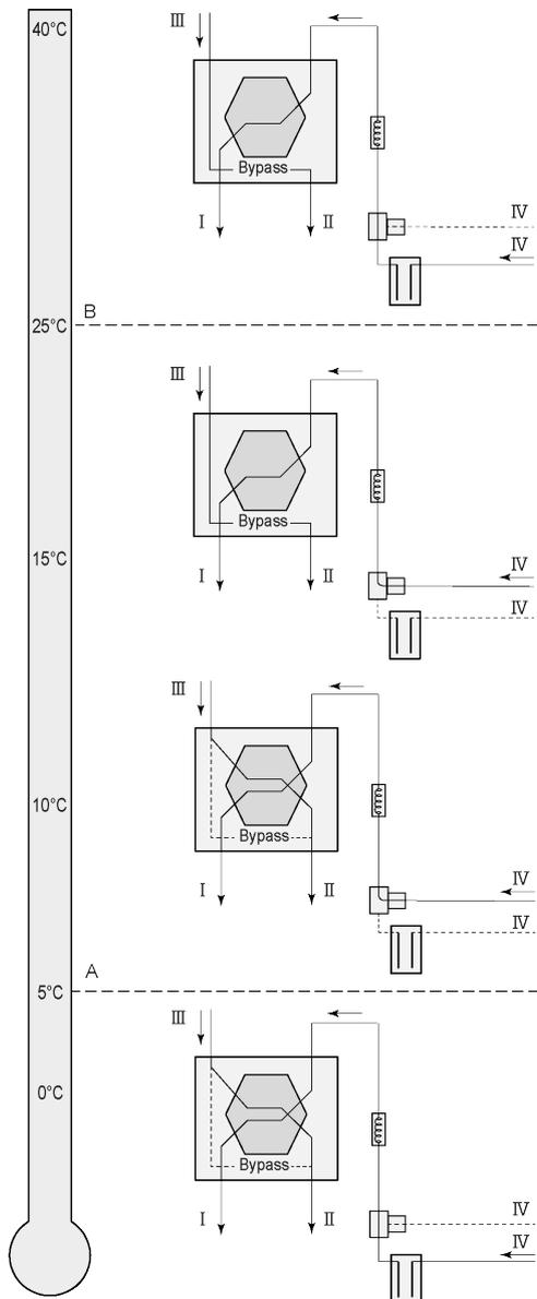
Mit der Plus-Platine kann ein Erdwärmetauscher an das Flair-Gerät angeschlossen werden.
