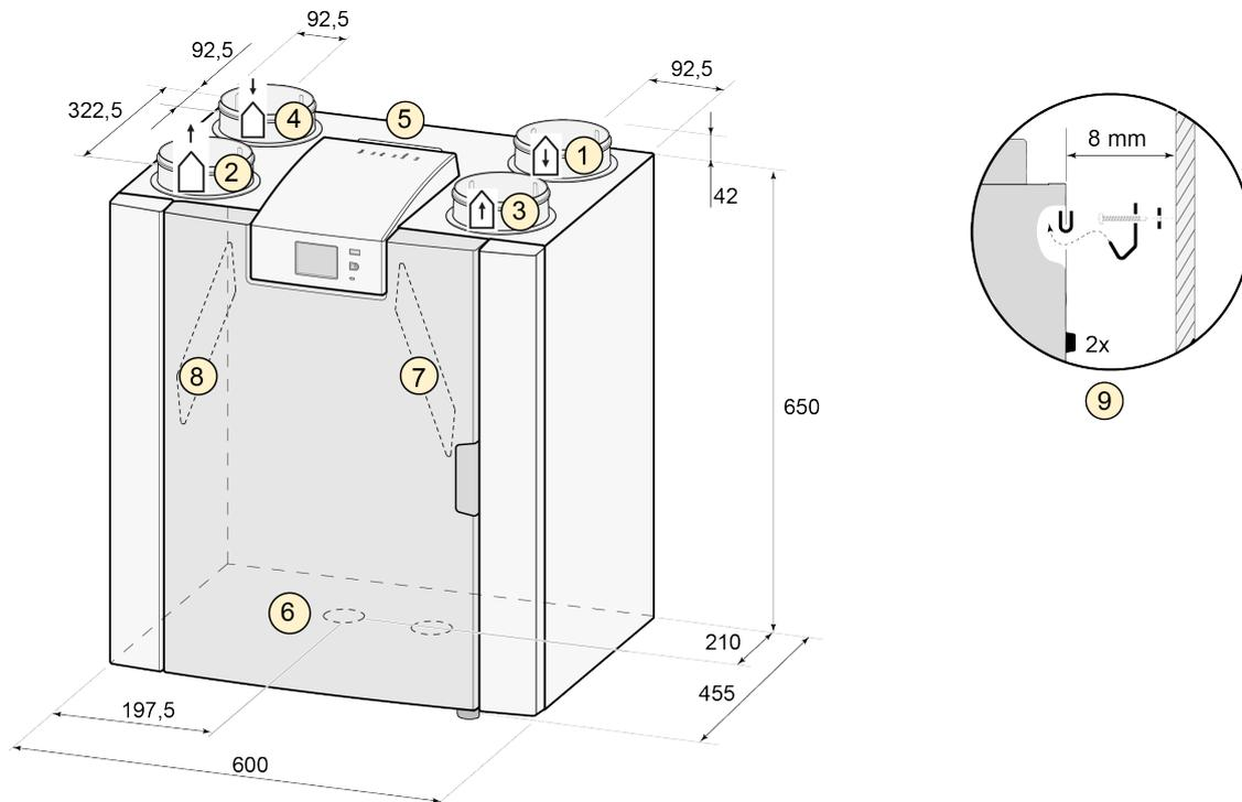
Alle Abmessungen sind in mm angegeben. Der Durchmesser sämtlicher Bundringe beträgt 125 mm.
