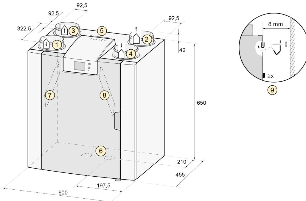
Alle Abmessungen sind in mm angegeben. Der Durchmesser sämtlicher Bundringe beträgt 125 mm.
